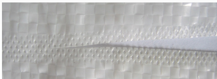
组合切割（超声波碾压+刀片切割）聚丙烯包装袋织物
